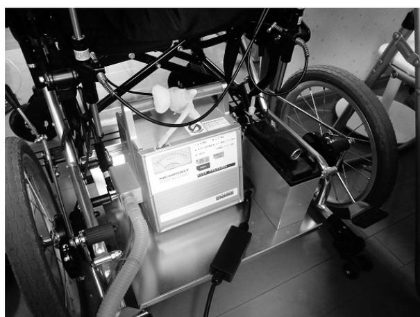
座面下には呼吸器とバッテリーを搭載する台
