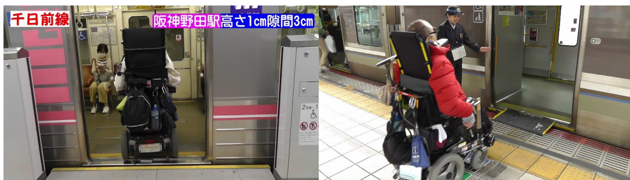
↑ スロープ無し（段差解消）は介助の必要がない
